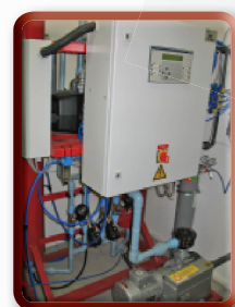
Zařízení pro úpravu složení atmosféry v testovacích boxech.
