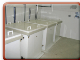
Testovací boxy s volitelným složením atmosféry a teplotou skladování.
